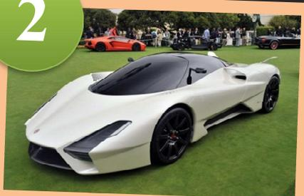
Вторым в тройке самых скоростных автомобилей значится SSC Tuatara. Это детище американских конструкторов имеет в своём активе двухтурбинный 6,9-литровый V-образный восьмицилиндровый мотор с предельной тягой в 1350 л. с. Укомплектованный таким двигателем, данный автомобиль способен добраться до сотни всего за две с половиной секунды. Максимальная скорость – 443 км/час. Согласитесь, полтора миллиона долларов – не слишком дорогое удовольствие для такого потрясающего экземпляра.
