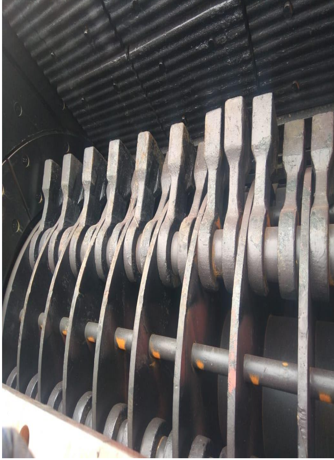
Молотковая дробилка СМ170В вид изнутри
